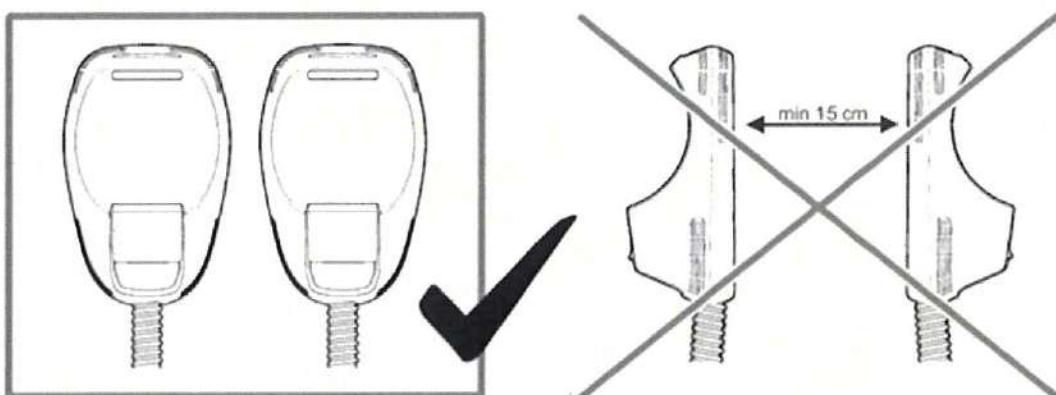
**警告：探頭位置不正確會給操作者帶來高電壓風險，並可能損壞設備。**
